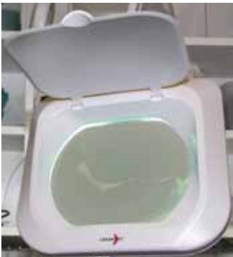
Lupeleuchte zur Inspektion der Medizinprodukte
