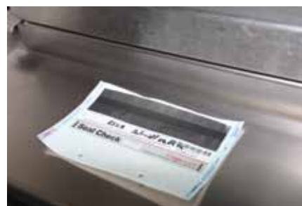
Seal-Check-Test: Arbeitstäglicher Test für die Siegelnaht
