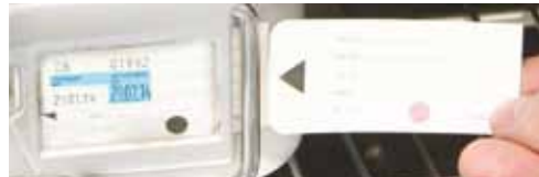
Prozessindikator ist vor der Sterilisation rosa und nachher schwarz eingefärbt.
