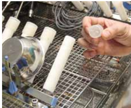
Angeschlossene und freie Injektordüsen werden mit Adapter verschlossen
