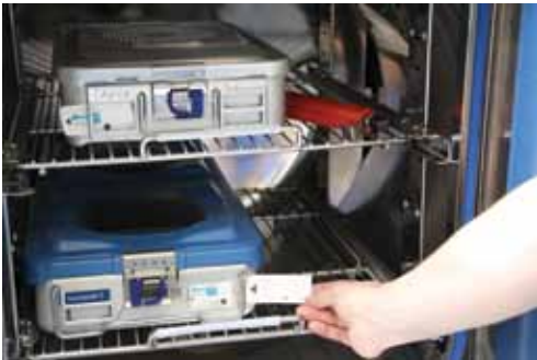
Bei der Beladung der Sterilisierkammern werden die entsprechenden Indikatoren mitbestückt. Oben: Roter Indikator = Helix-Test Unten: Prozessindikator
