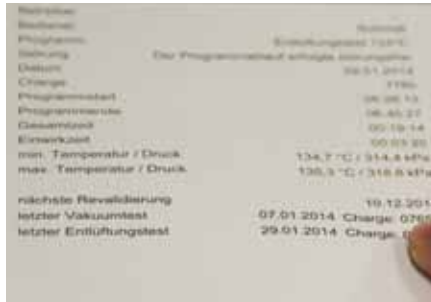
Ausdruck der EDV-gestützten Dokumentation nach der Sterilisation
